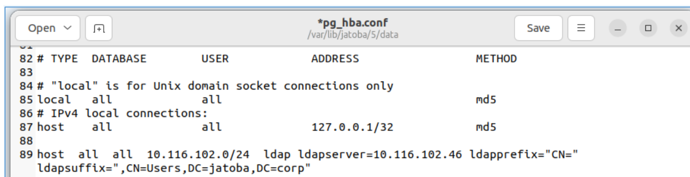
Рисунок 5.25 – Конфигурационный файл pg_hba.conf для аутентификации по атрибуту 'cn'
